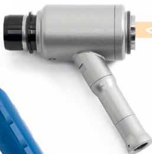
REF 5163nou Редуктор с блоком уплотнителей, включая уплотнители и ключ- фиксатор. Вращение от двигателя передается на нож-тубус через редуктор, который изменяет частоту вращения в необходимом соотношении.
